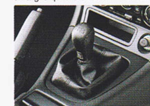
Le pommeau du levier de vitesses a été élaboré à partir d'un modèle en argile qui a été testé sur circuit.
