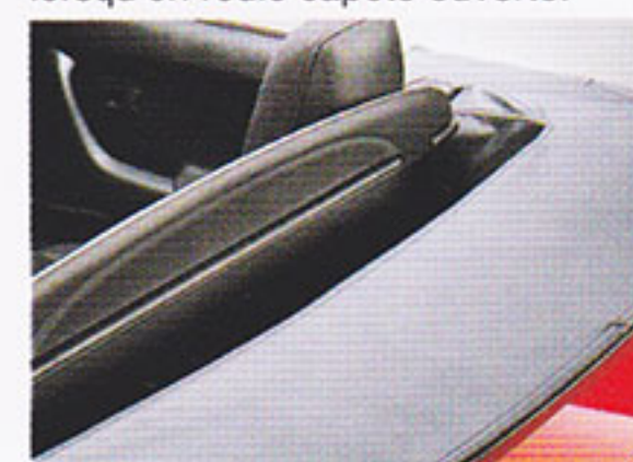
Le design du saut de vent a été modifié pour éviter les remous d'air lorsqu'on roule capote ouverte.
