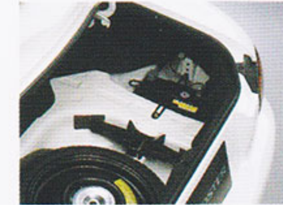
Dans le but de réduire le poids de la MX-5, la batterie est dérivée de celles employées sur les motos.
