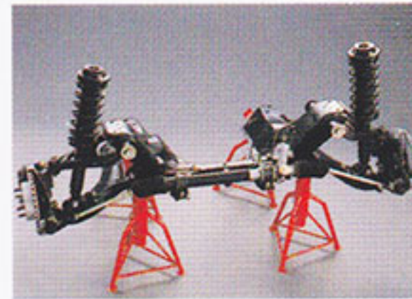
La suspension à double triangulation sur les quatre roues comporte différentes pièces réalisées à la main.
