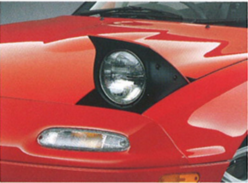
リトラクタブルハロゲンヘッドランプ (ワンタッチパッシング機能付き) (全車標準装備)
