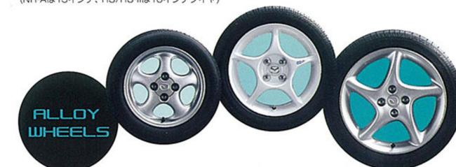
●185/60R14 82Hタイヤ+6JJアルミホイール(M、SP、S、VS Combination A、VS Combination B)
