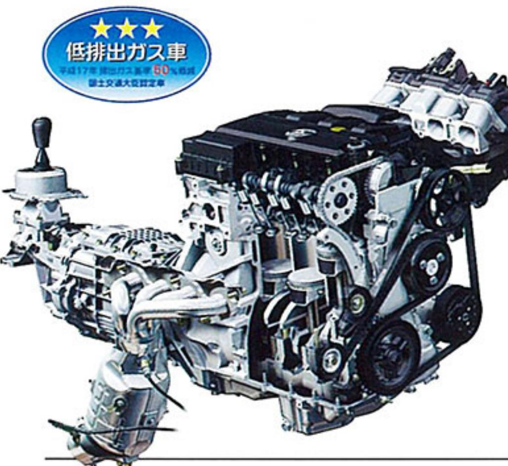
新型ロードスターが搭載する新開発の小型軽量 MZR 2.0ℓ エンジン。その真の魅力はパワーフィールとエンジンサウンドにある。そしてこれらの特質を実現しているのが、●吸気バルブの開閉タイミングをエンジン回転数に即して最適制御する S-VT (シーケンシャル・バルブタイミング) ●低回転から高回転までリニアでスムーズなトルク感をもたらす可変吸気システム (VIS) ●10.8 の高圧縮比 ●専用開発の軽量フライホイール(マニュアル車) ●大径エレキスロットルなどである。そして、吸気抵抗を先代モデル\*比で 57%、排気の圧力
