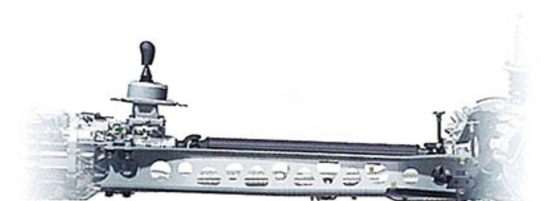
ドライバーによるアクセルワークをダイレクトにクルマに伝えることも、人馬一体の走りを支える大切な性能のひとつ。その鍵を握るのがドライブトレインの高剛性化である。新型ロードスターでは、新しいZ型断面のアルミ製P.P.F.(パワープラントフレーム)でパワーユニットとファイナルドライブユニットをリジッドに結合。アクセルによるドライバーの意思を後輪にリニアにダイレクトに伝えることで、クルマとの確かな一体感をより際立たせて
