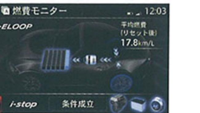
燃費情報、各種のメンテナンス情報や注意情報、インテリジェント・ドライブ・マスター(i-DM)情報などを表示。i-ELOOP(アイ・イーループ)搭載車はその制御情報も確認できる。
