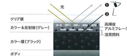
「匠塗 TAKUMINURI」独特の、高精度で規則的に並んだ高輝度アルミフレークが、なめらかかつシャープにハイライト部(①:光が反射して見える部分)を輝かせます。一方のシェード部(②:光が反射せず、影になっている部分)は、2層のカラー層が重なり合った深みのある黒味の強いグレーを実現。光の強弱によって豊かに表情を変えるカラーが、魂動デザインのプロポーション、エッジ、面構成の美しさを際立たせます。
