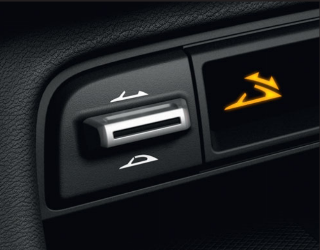
OPENINGSKNOP VAN HET DAK VAN DE RF
