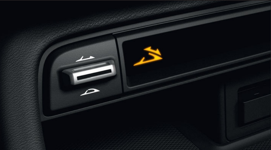
OPENINGSKNOP VAN HET DAK VAN DE RF
