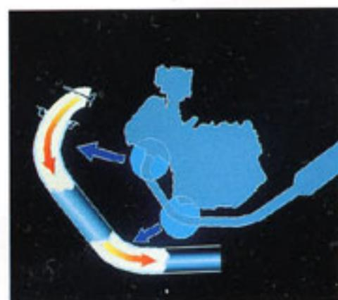
エンジン前傾化によりエキゾーストパイプの曲率を大きく取り、スムーズな排気を実現。
